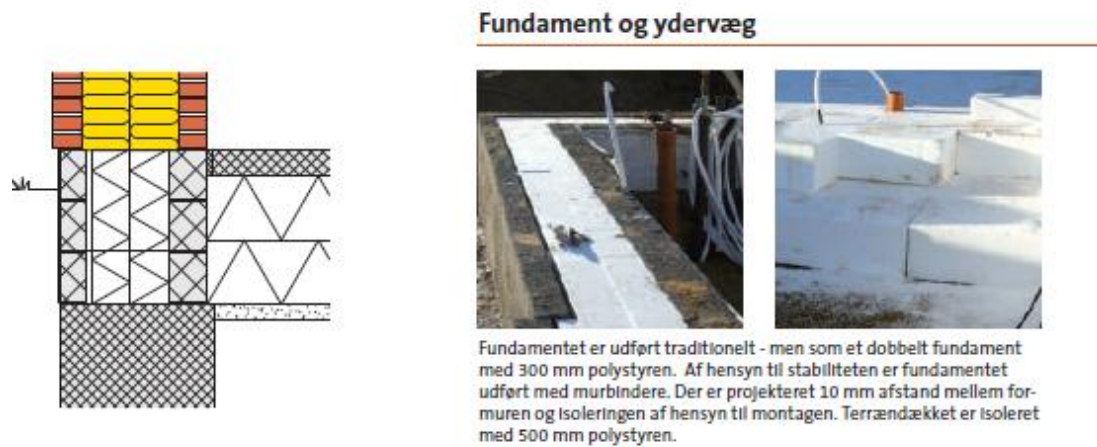
Figur 12 Fundamentsdetalje for fuldmuret passivhus i Komforthus-projektet - Stenagervænget 12 ( \Psi_{\text{Fundament}} = 0.08 \text{ W/m}^2\text{K} , linitab konverteret til udvendige mål jf. passivhus-standard \Psi_{\text{Fundament}} = 0.0 \text{ W/m}^2\text{K} ). [13]
