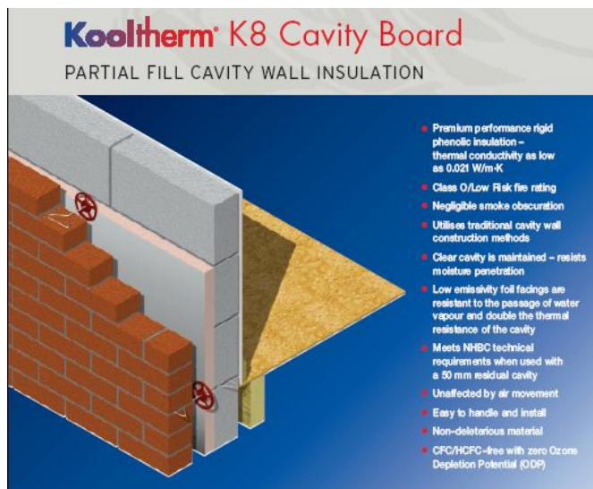
Figur 6 britiske Kingspan markedsfører PUR-isolering med deklareret lambda-værdi på 0.021
