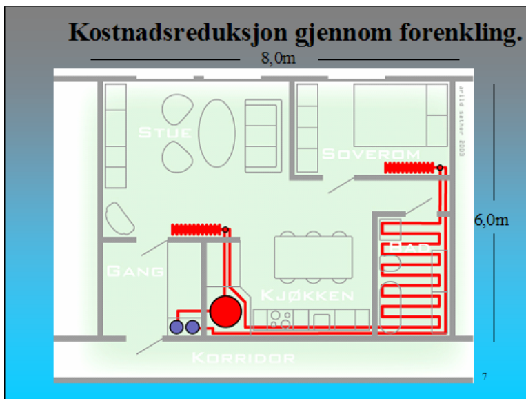
Figur 4.35 Skjematisk skisse på forenklet og kostnadseffektiv vannbåren løsning i lavenergi-leilighet. Illustrasjon og ide: Leif Amdahl, VVS-foreningen [19].
