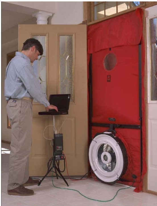
Figur 5.2 Utstyr for trykktesting av bygg. Bilde: Minneapolis Blower Door™ ( www.energyconservatory.com )
